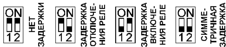
Рис. 6. Внутренние переключатели датчика.
